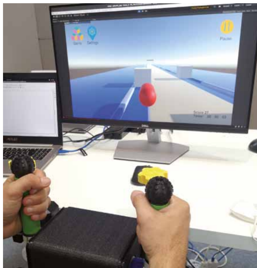
Sul cubo, dotato di due motori e alcuni sensori, si innestano manovelle, manopole, leve, che consentono di muovere in modo controllato ed equilibrato le spalle, i gomiti, i polsi di una persona con disturbi neurologici, mentre interagisce con un gioco sullo schermo.
